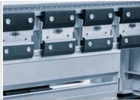
Promecam Kalıp Bağlama Sistemi Promecam Top Tool Clamping System
